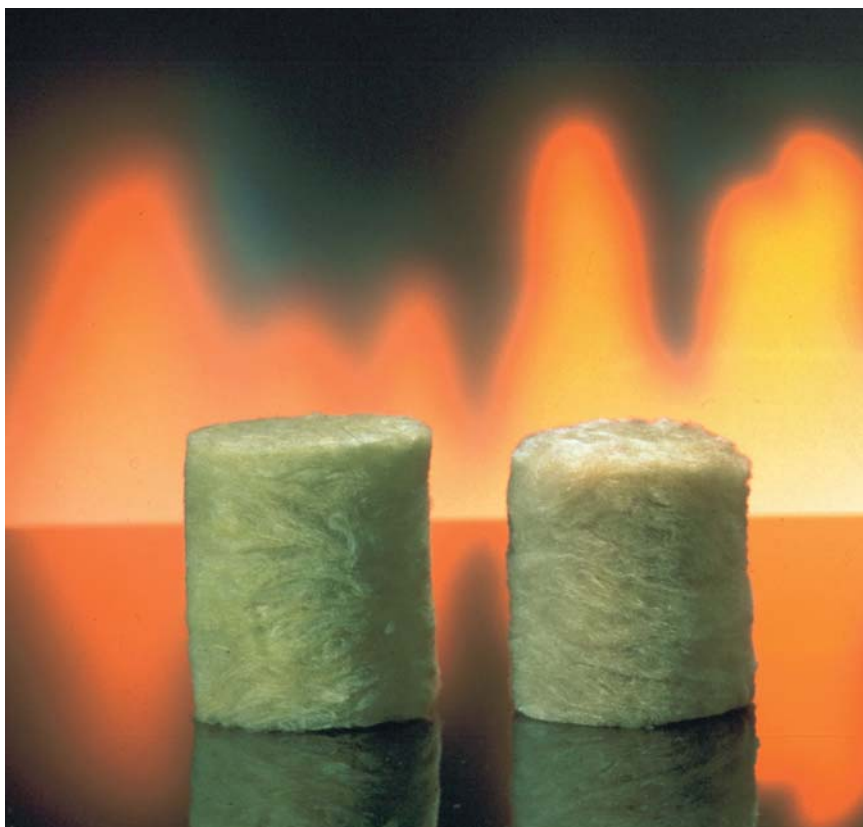
PAROC® Steinull motstår svært høye temperaturer. Bildene viser et eksempel av PAROC eXtra-produktet før og etter en ikke-forbrenningstest iht. EN ISO 1182, der testgjenstanden brennes ved en temperatur på 750 °C.
