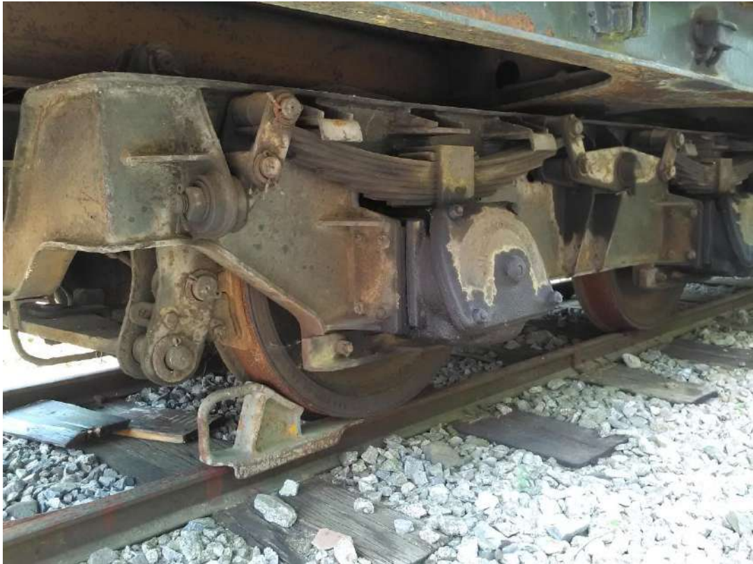
podvozok vozňa s detailom ložísk a vyprużenia
