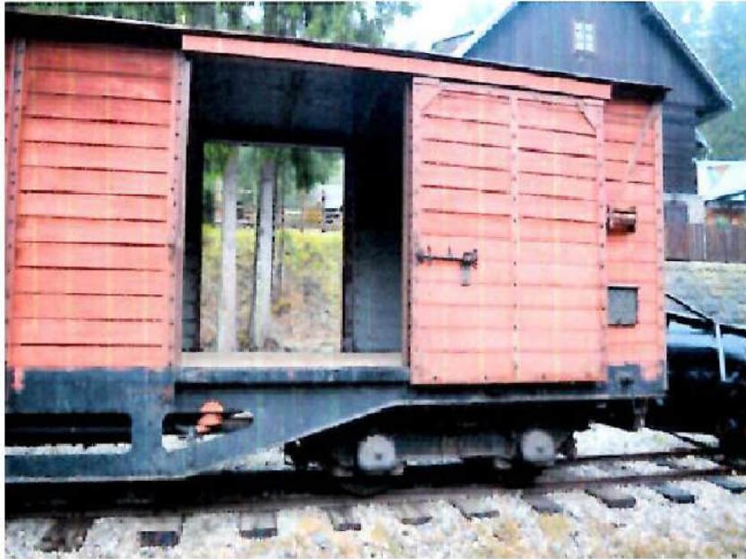
otvor vagónu, určený na osadenie posuvných dverí
