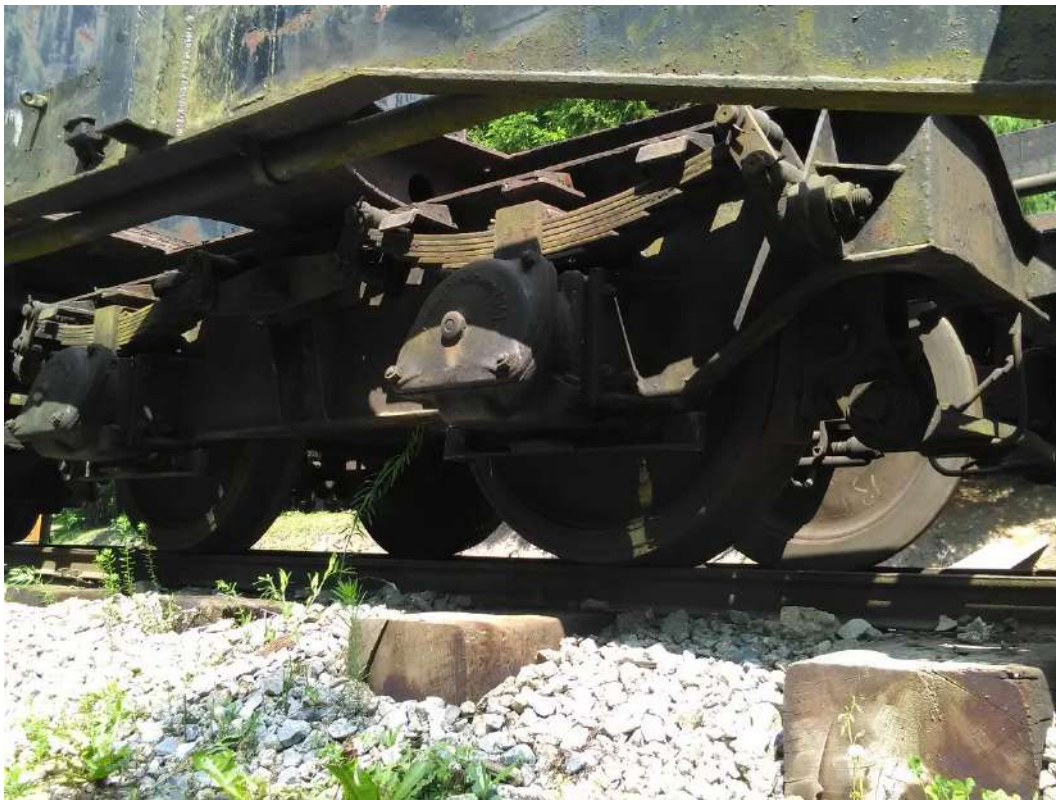
podvozok vozňa s detailom ložísk, vypruženia a časti hlavného rámu
